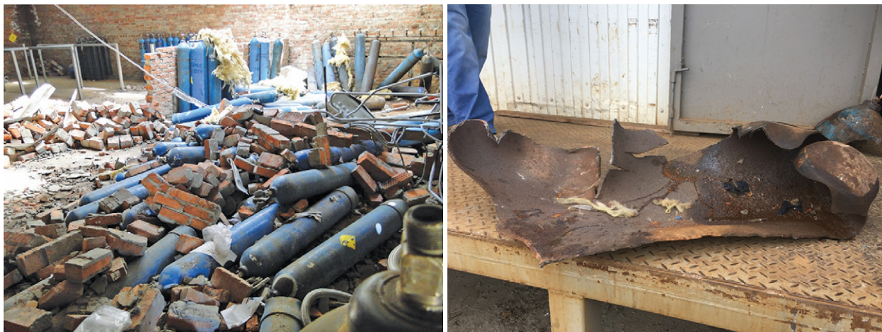
Рис. 33. Взрыв баллона при перемещении работником ЗАО «Кубаньтехгаз»
