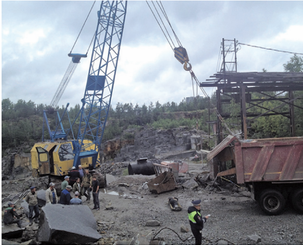
Рис. 56. Придавливание рабочего при перестановке краном установки алмазно-канатного пиления в кузове автосамосвала на территории карьера
